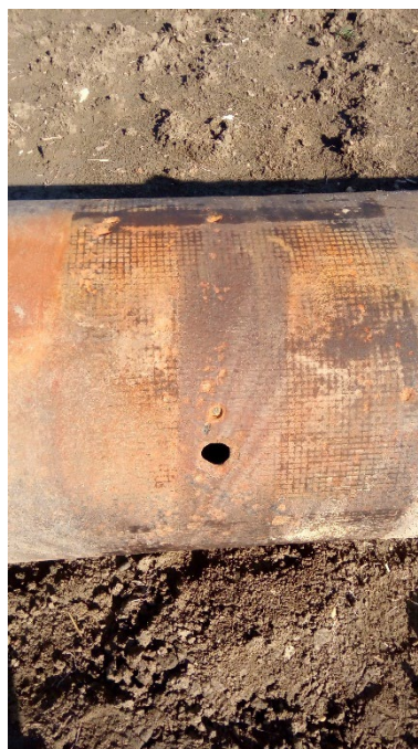
Fuites sur la canalisation source « la Dame » Fonte DN500mm (octobre 2016 et juillet 2017)
